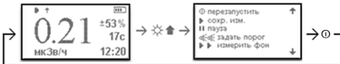
Рисунок 4. Вызов окна помощи из окна основного измерения
